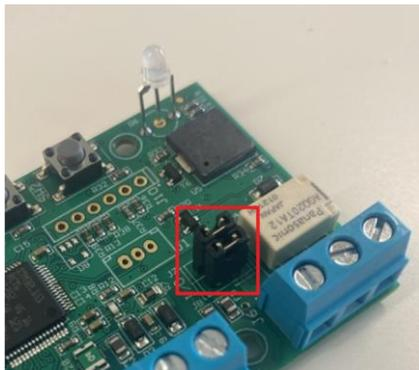
Se ha de conectar los Jumper en horizontal, tal como se indica en el siguiente esquema:
