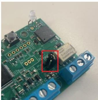
Para esta configuración únicamente se ha de conectar el Jumper en posición vertical tal como se indica
