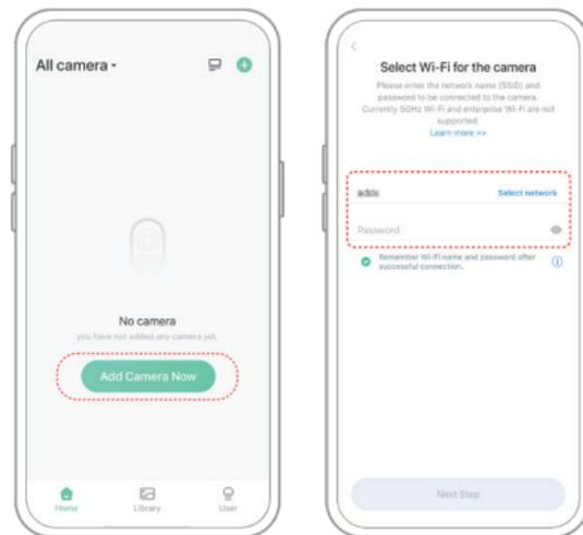
Para garantizar una conexión de mayor distancia, la cámara solo es compatible con Wi-Fi de 2,4 Ghz con una capacidad de penetración de pared más fuerte y no es compatible actualmente con Wi-Fi para la autenticación de nivel empresarial . Asegúrese de que el Wi-Fi ingresado cumpla con los requisitos. Una vez completado, haga clic en "Continuar" para generar el código QR para emparejar la cámara.
