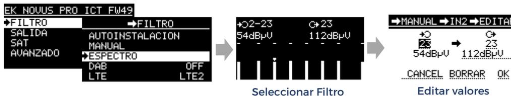
La opción ESPECTRO permite realizar las mismas acciones sobre los filtros que la opción MANUAL, con la ventaja adicional de que, de un vistazo, se pueden ver todos los filtros programados y no es necesario seleccionar la entrada. Es simplemente una potente alternativa, ofreciendo al instalador la libertad de elegir la opción que prefiera para gestionar los filtros según sus preferencias.
