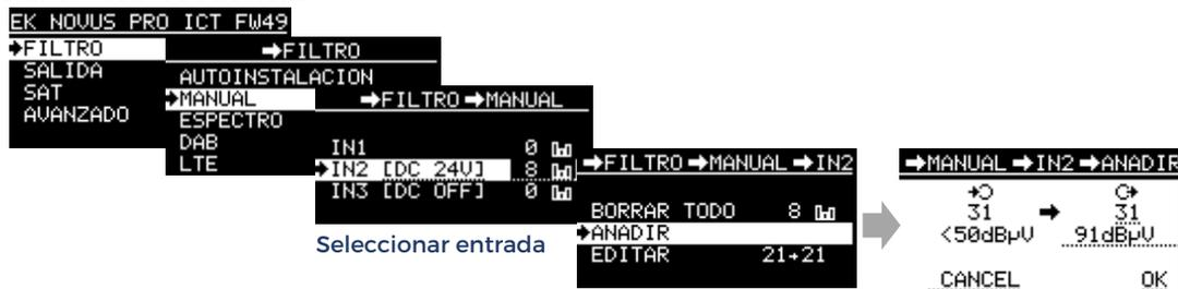
**Editar un filtro existente:** Con las teclas superior e inferior del joystick, seleccione el filtro que desea editar. Esta opción permite modificar la frecuencia, el nivel o eliminar el filtro seleccionado.
