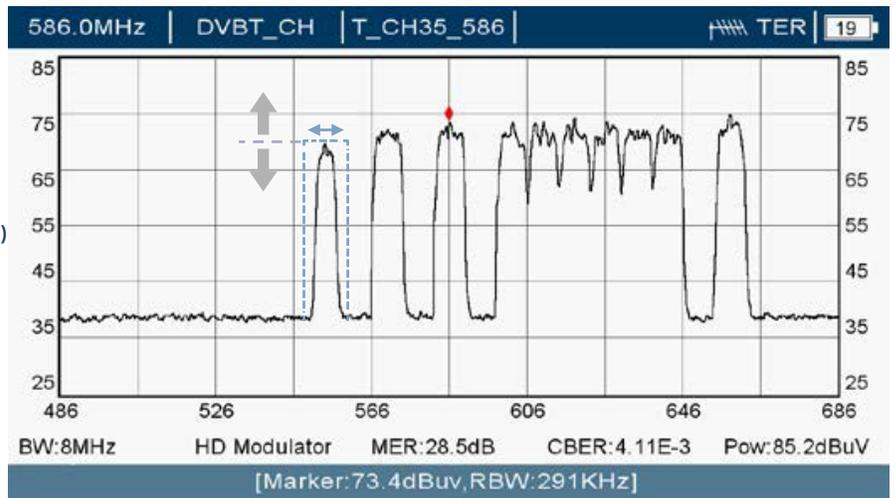
**Ajuste de la frecuencia de salida (filtro seleccionado):** Con las teclas laterales del joystick, el instalador puede cambiar la frecuencia de salida del filtro seleccionado. Para confirmar los cambios, debe pulsar el botón central del joystick.
