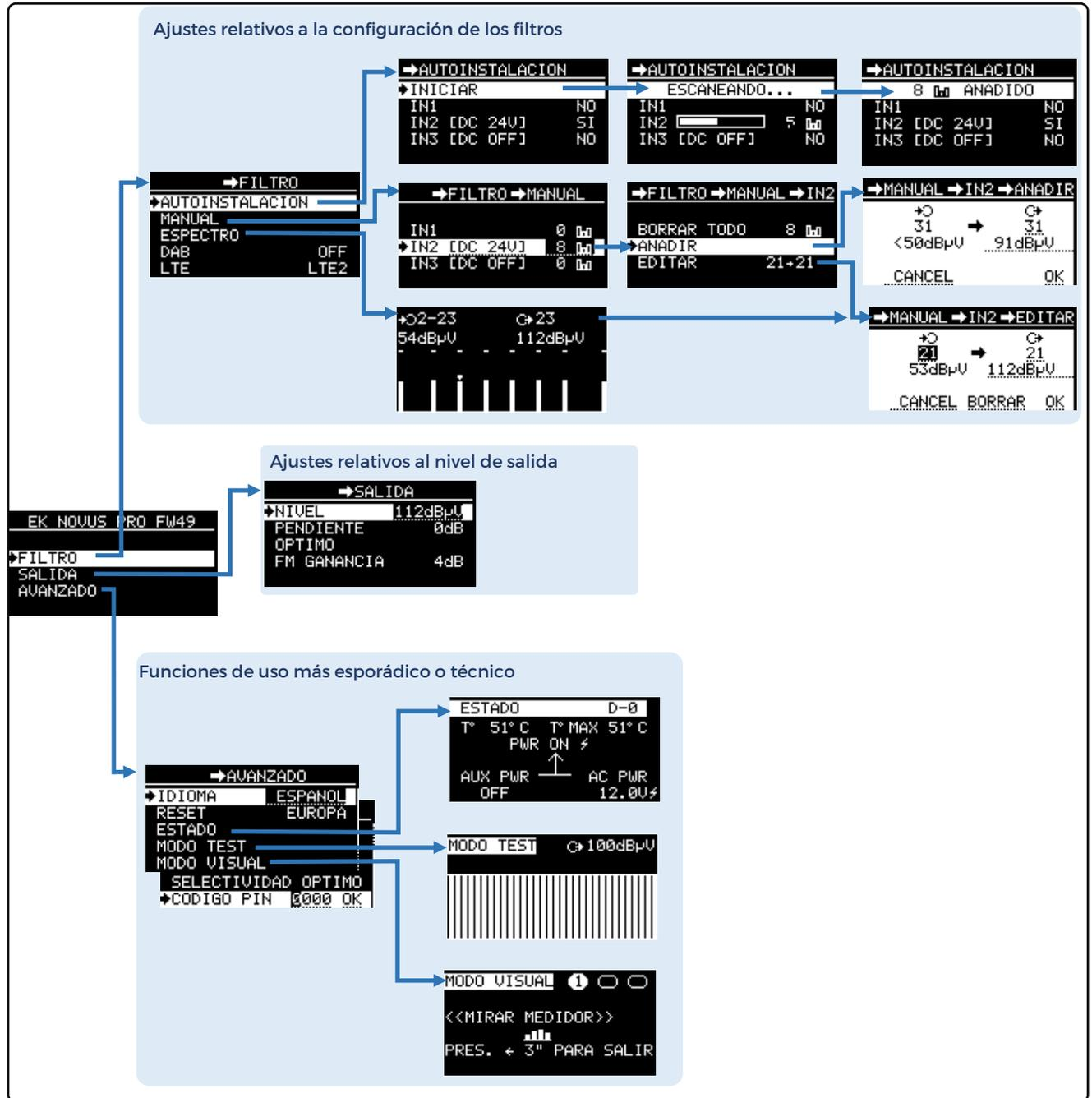
Durante la navegación por los submenús, la barra superior de la pantalla indica en todo momento la ubicación jerárquica utilizando un rastro de navegación o "miga de pan". Esto permite que el usuario siempre sepa exactamente en qué sección del menú se encuentra.
