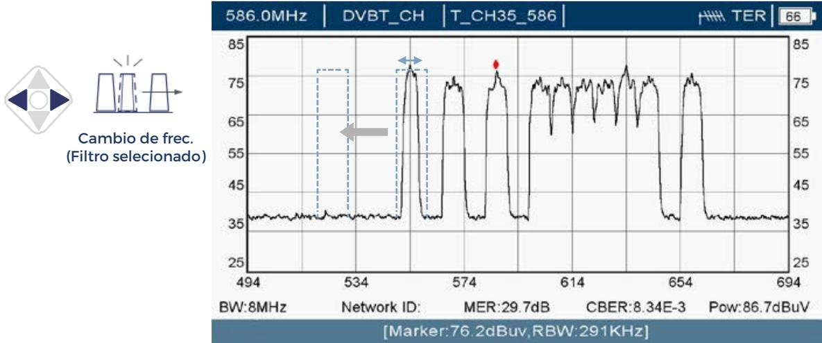
**Borrado de un filtro (filtro seleccionado):** Al mantener pulsada la tecla inferior del joystick durante 3 segundos, el filtro seleccionado será eliminado.
