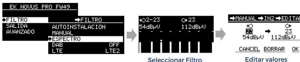
La opción ESPECTRO permite realizar las mismas acciones sobre los filtros que la opción MANUAL, con la ventaja adicional de que, de un vistazo, se pueden ver todos los filtros programados y no es necesario seleccionar la entrada. Es simplemente una potente alternativa, ofreciendo al instalador la libertad de elegir la opción que prefiera para gestionar los filtros según sus preferencias.
