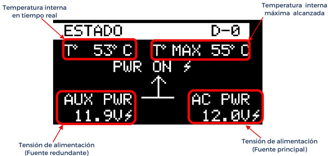
Si no hay una fuente redundante conectada, se muestra OFF.
