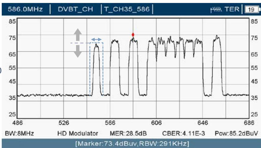
**Ajuste de la frecuencia de salida (filtro seleccionado):** Con las teclas laterales del joystick, el instalador puede cambiar la frecuencia de salida del filtro seleccionado. Para confirmar los cambios, debe pulsar el botón central del joystick.
