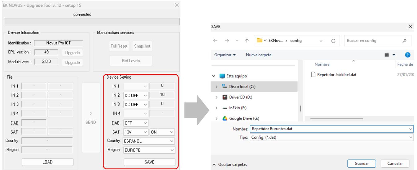
Para copiar una de las configuraciones guardadas a otra central, seleccione el archivo deseado utilizando el botón LOAD:
